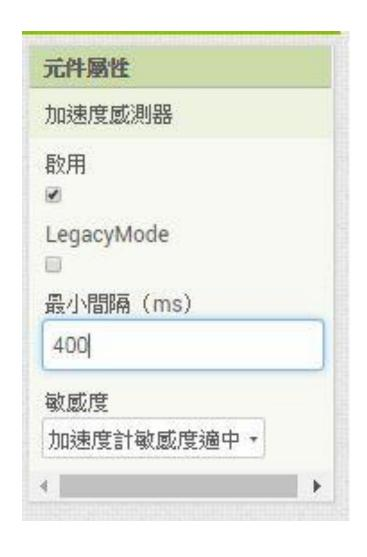
用於偵測晃動,並測出加速度三軸分量的近似值,單位為米/秒<sup>2</sup>。 X分量:當手機在平面上靜止時, 其值為零;當手機向左傾斜時(即, 右側升起),其值為正;而向右傾斜時(左側升起),其值為真。
